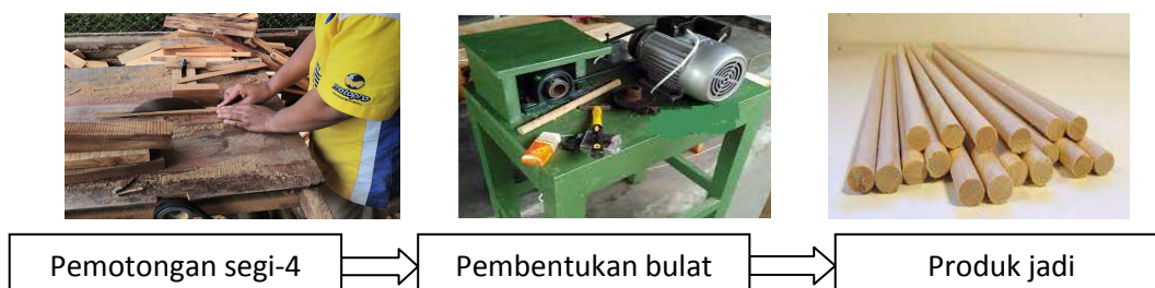
Gambar 14. Proses pemotongan/pembentukan poros menggunakan mesin dowel
