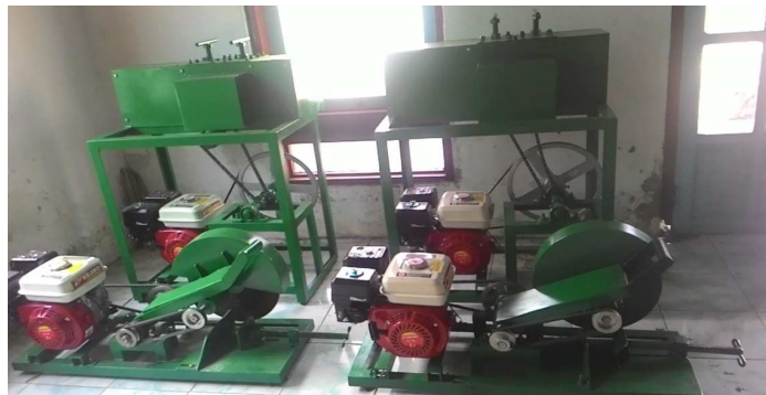
Gambar 2. Mesin pemotong dan pengirat bambu sebagai alat inovasi kerajinan bambu
