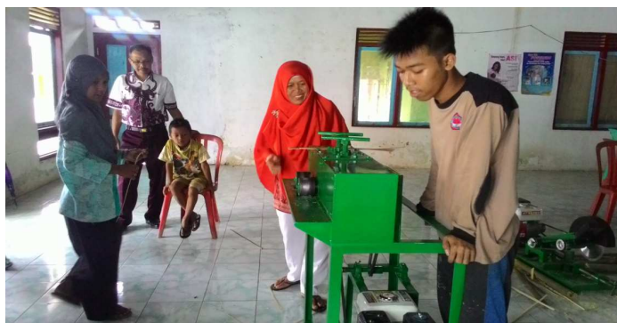
Gambar 3. Peserta pelatihan dalam mencoba melakukan pengiratan bambu dengan mesin
